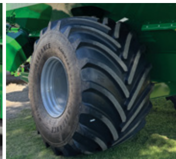
TREN DE RODAJE: NEUMÁTICOS 1250/50 R32
