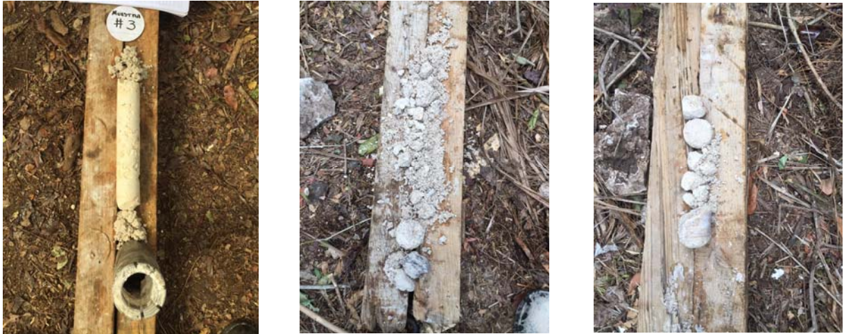
Figura 2. Muestras de roca caliza a diferentes profundidades en un mismo sondeo
