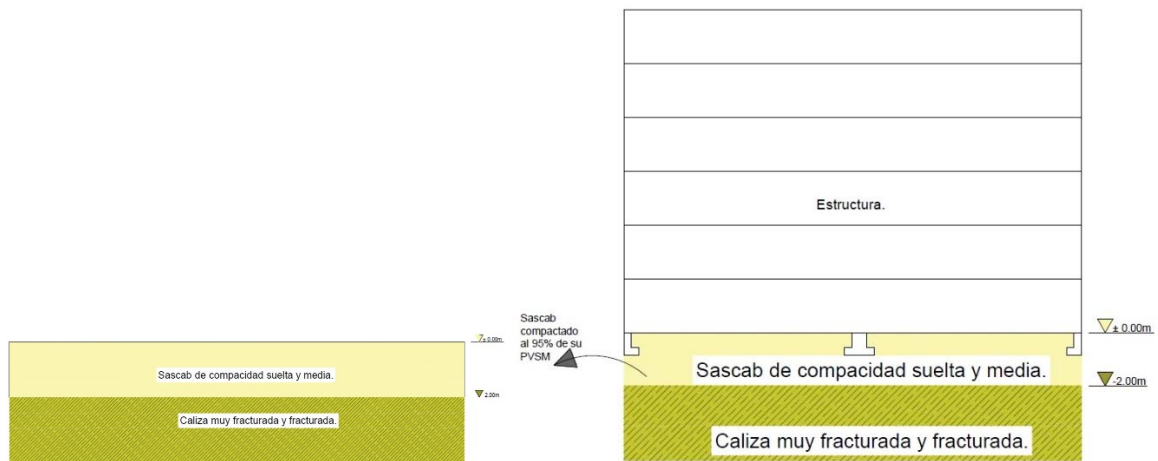
Figura 5. Solución con desplante de cimentaciones superficiales sobre plataformas compactadas de sascab
