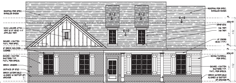
1 Front Elevation 'C' A13 SCALE: 1/4" = 1'-0"
