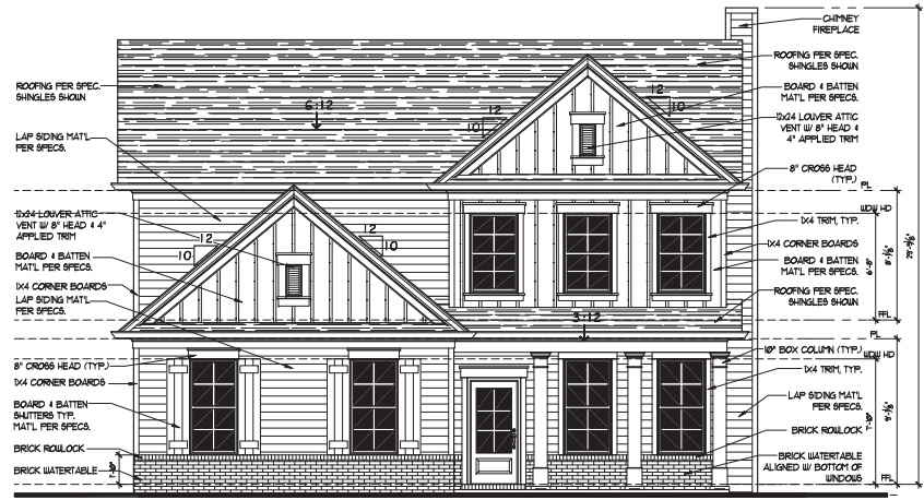
1 Front Elevation 'B' A12 SCALE: 1/4" = 1'-0"
