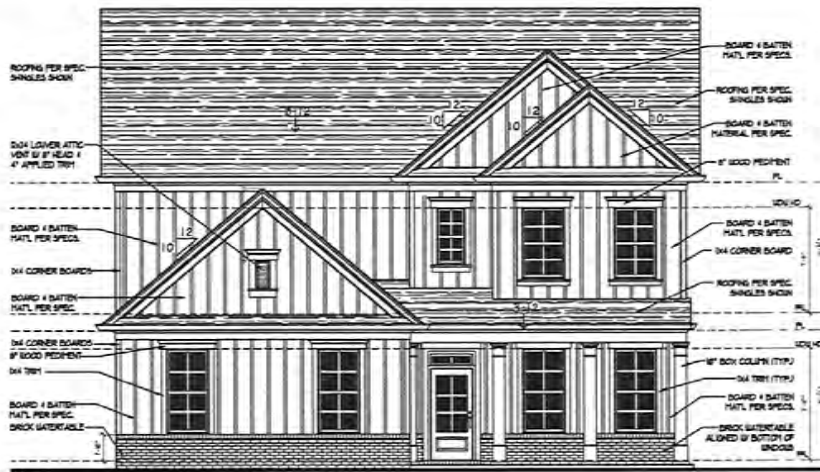
1 Front Elevation 'B' A1.2 SCALE: 1/4" = 1'-0"
