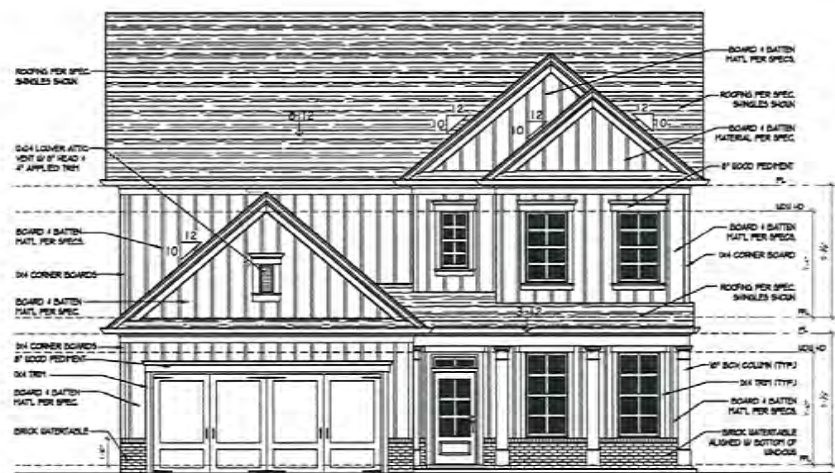
1 Front Elevation 'B' A1.2 SCALE: 1/4" = 1'-0"
