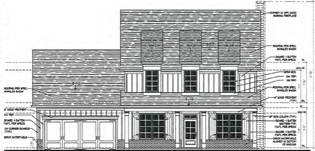
1 Front Elevation 'B' A1.2 SCALE: 1/4" = 1'-0"
