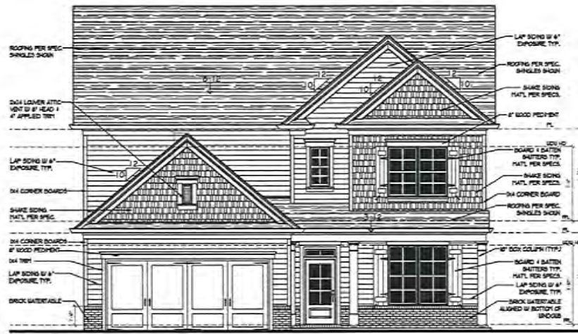
1 Front Elevation 'C' ALS SCALE: 1/4" = 1'-0"
