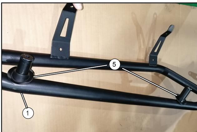
Placer les bouchons B **(5)** en position d'installation sur le nerf barre **(1)** comme illustré.
