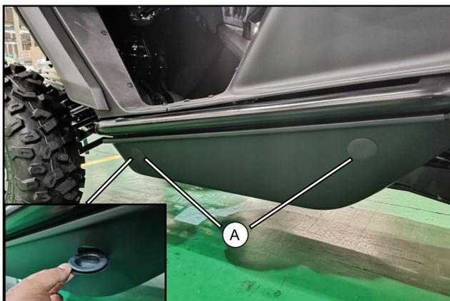
Retirez les bouchons de protection **(A)** de la carrosserie du véhicule.
