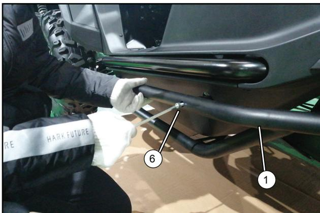
Positionnez la barre nerf en position d'assemblage comme illustré, puis installez les vis hexagonales intérieures **(6)** mais ne les serrez pas à ce moment.
