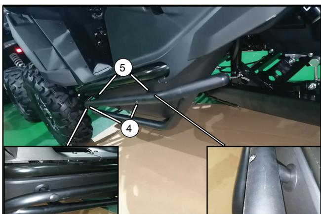
Poussez les bouchons B (5) dans la carrosserie du véhicule et installez les bouchons A (4) pour terminer l'assemblage.
