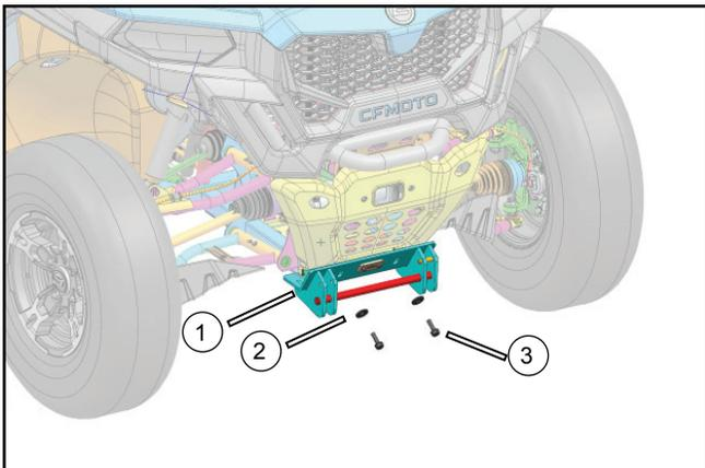
Alignez le support du chasse-neige (1) sur le véhicule avant et fixez-le avec les boulons (3) et les rondelles (2).
