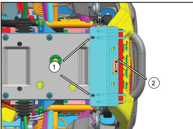
Desserrez les boulons de la plaque de protection avant (1) à l'emplacement indiqué. Alignez les fentes du support de chasse-neige et poussez le support (2) sur les boulons. Serrer les boulons (1).
