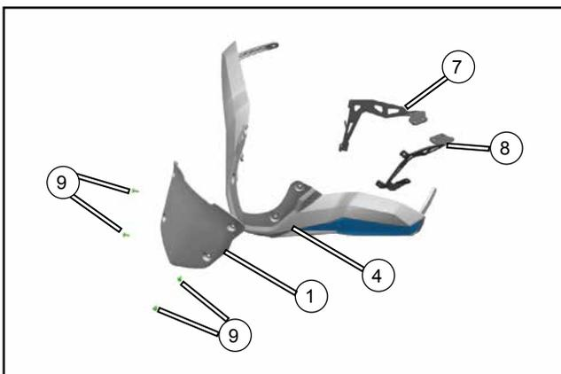
Installez la vitre de pare-brise (1), le support de pare-brise gauche (8) et le support de pare-brise droit (7) sur le protège-main avant (4) avec des boulons (9). Ne serrez pas complètement les boulons à ce stade.
