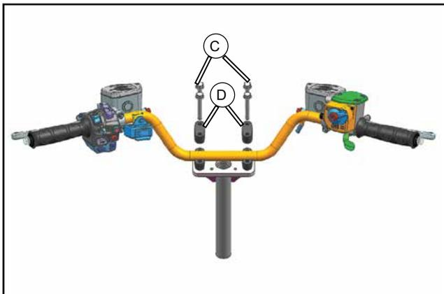
Retirez les boulons de serrage du guidon (**C**) et les colliers (**D**).
