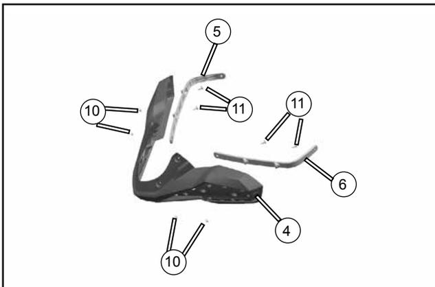
Fixez le levier de garde-main gauche (6) et le levier de garde-main droit (5) à l'intérieur du protège-main avant (4) avec des boulons (11) et écrous (10).
