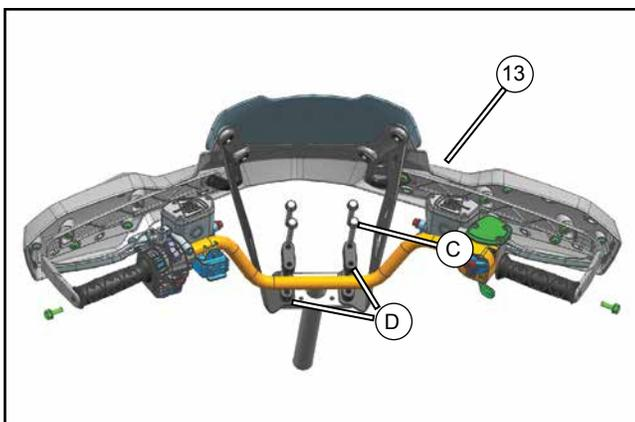
Installez l'ensemble pare-brise (**13**) sous les pinces de guidon (**D**). Réinstallez les boulons de serrage et coupler uniformément selon les spécifications.
