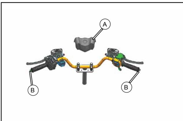
Retirez la protection supérieure du guidon (A) et les boulons (B) aux deux extrémités du guidon.
