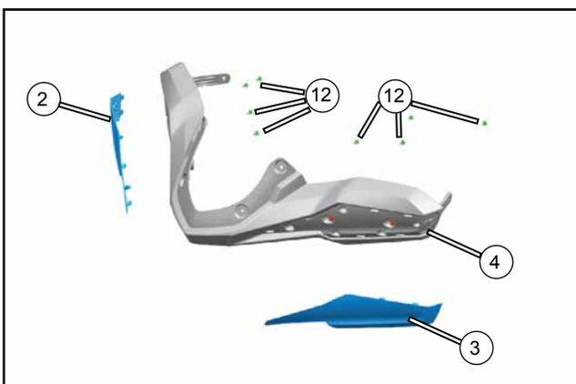
Installez la protection déco droite (2) et la protection déco gauche (3) à l'extérieur du protège-main avant (4), et fixez-les avec les vis (12).
