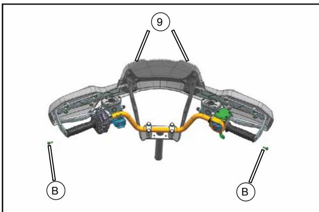
Réinstallez les boulons (**B**) aux deux extrémités du guidon. Serrez suffisamment en prenant soin de ne pas trop serrer.
